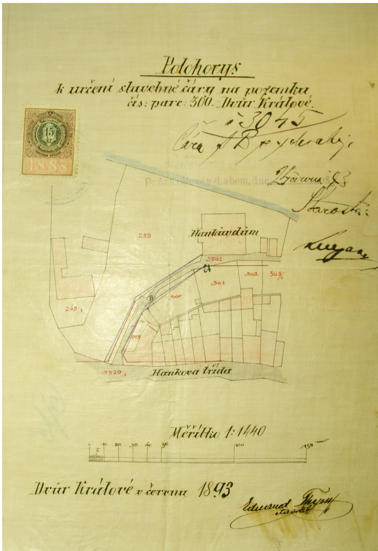
Obr. 3: Situace s určením budoucí stavební čáry na pozemku budoucí sokolovny, Eduard Thym, červen 1893 (MěÚ Dvůr Králové nad Labem, archiv stavebního odboru).
